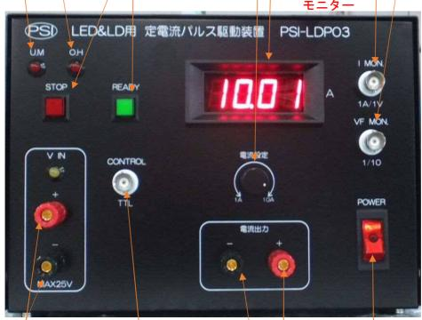
②: 外部電源入力端 ③: TTL 入力信号⑨ ⑧ ①: 電源オン、オフ 赤: + 電流出力端子
