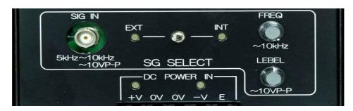
信号入力の選択を "EXT"に設定します SIG IN と 外部SGを BNCコードで接続します (入力抵抗  $10K\Omega$ )
