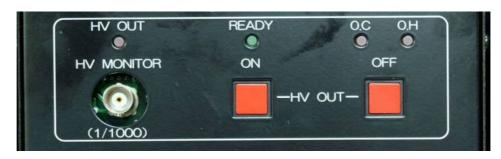
HV MONITOR BNC 出力 1/10 プローブ 又は BNCコードでオシロスコープに接続します オシロスコープの入力終端を  $High\ Z(1M\Omega)$ とします 高電圧レベルの 1/1000倍が観測出来ます
