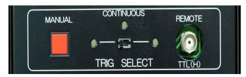
TRIGモード の選択を "REMOTE"に設定します
